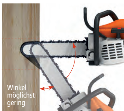
Bei Stechschnitten Säge unter flachem Winkel zur Werkstückoberfläche ansetzen. Beim Einstechen ständig Druck auf den unteren Teil der Sägekette ausüben.
