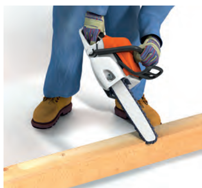
Abgeschrägte Schwertschneidspitze vermindert Rückschlaggefahr
