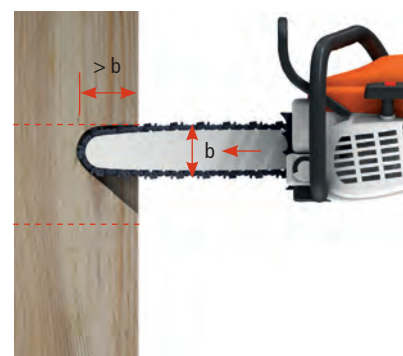
Erst wenn die Schienenspitze mehr als das Maß der Schienenbreite eingetaucht ist, Stechschnitt vollständig durchführen.
