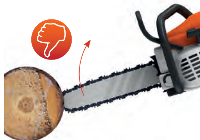
Rückschlaggefahr im Bereich der oberen Schwertschneidspitze
