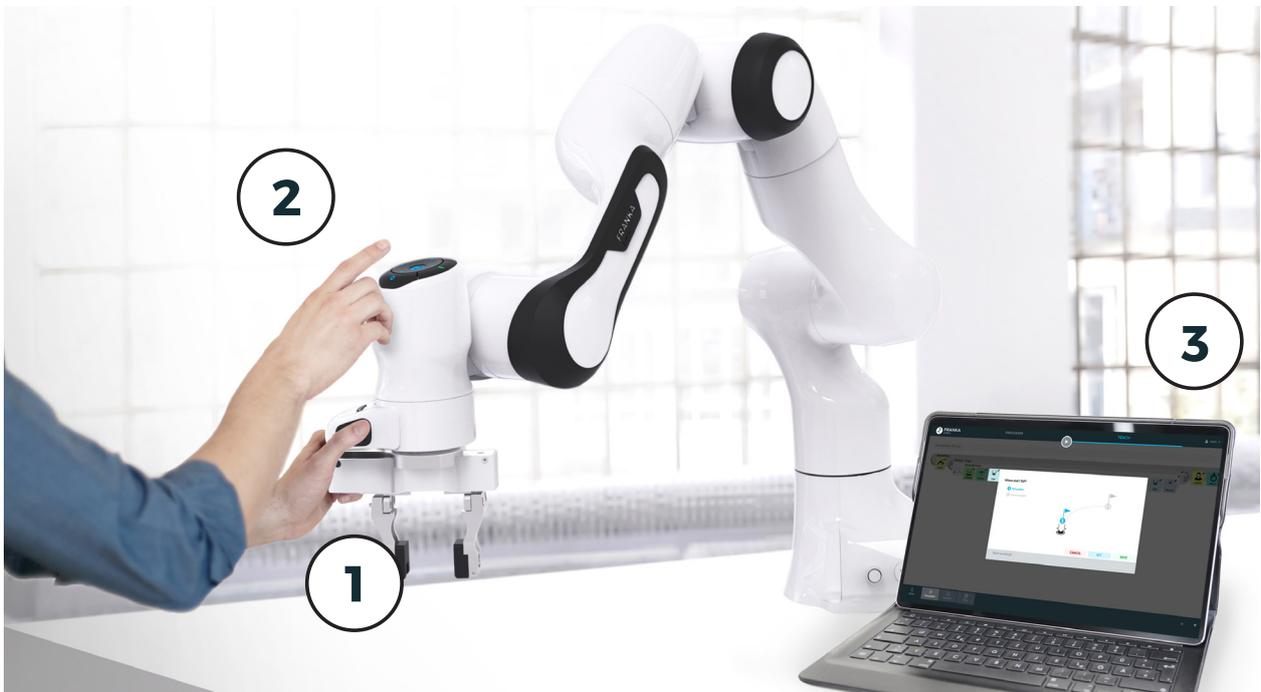
1. Am Griff des Piloten befinden sich rechts und links zwei graue Taster, die durch Drücken ein Führen des Arms ermöglichen (Guiding). Werden die Taster losgelassen, wird der Arm wieder steif und kann nicht mehr bewegt werden.
