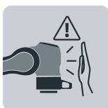
Die App 'Set Collision Thresholds' erlaubt das Einstellen von Kollisionsschwellen. Da Panda über eine externe Kraft- und Momentenschätzung auf Basis interner Sensorik verfügt, kann der Arm beim Überschreiten von bestimmten Kraft- oder Momentenschwellen seine aktuell ausgeführte Tätigkeit abbrechen. Die Schwellen sollten immer in Hinblick auf die auszuführende Aufgabe gewählt werden. Die eingestellten Werte gelten nun für alle folgenden Apps.
